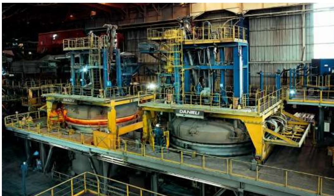
Рисунок 2 – Двухпозиционный вакууматор DANIELI как элемент интеллектуальной системы внепечной обработки стали
